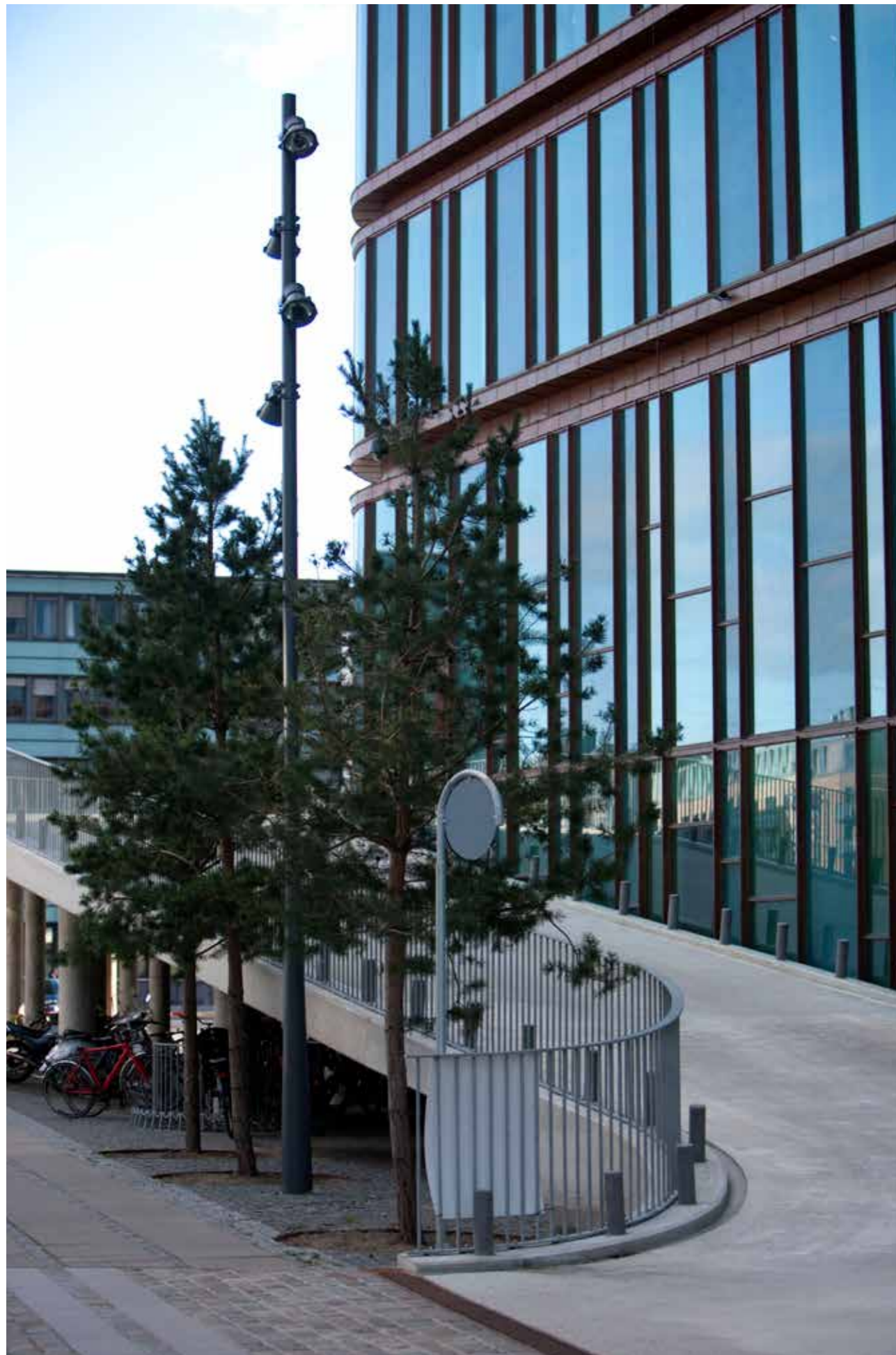
SEB-Haus, Kalvebod Brygge. Der High-Light-Mast wurde von SLA gezeichnet und ist aus Aluminium gefertigt, das in einem Stück ohne Schweißnähte gepresst wird.
